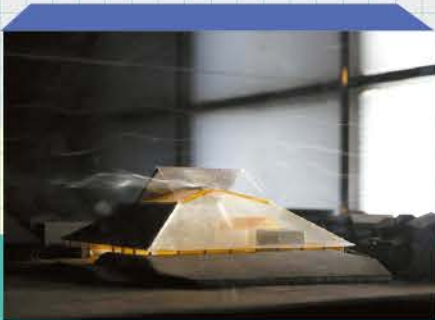
「直島ホール」風洞実験模型 / 三分一博志 © 三分一博志建築設計事務所
